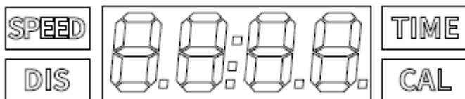
Устройство оснащено светодиодным дисплеем, на котором отображаются следующие параметры: скорость, время, расстояние и калории.
