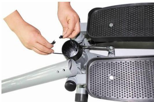
6. Зафиксируйте стойку (5) при помощи винтов M8x20 (43) и шайб (49).
