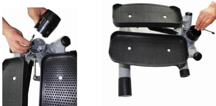
3. Соедините нижнюю (5) и верхнюю (4) части стойки, зафиксируйте детали при помощи штифта (9).
