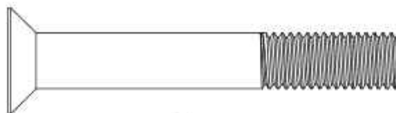
Болт с потайной головкой M10*70
