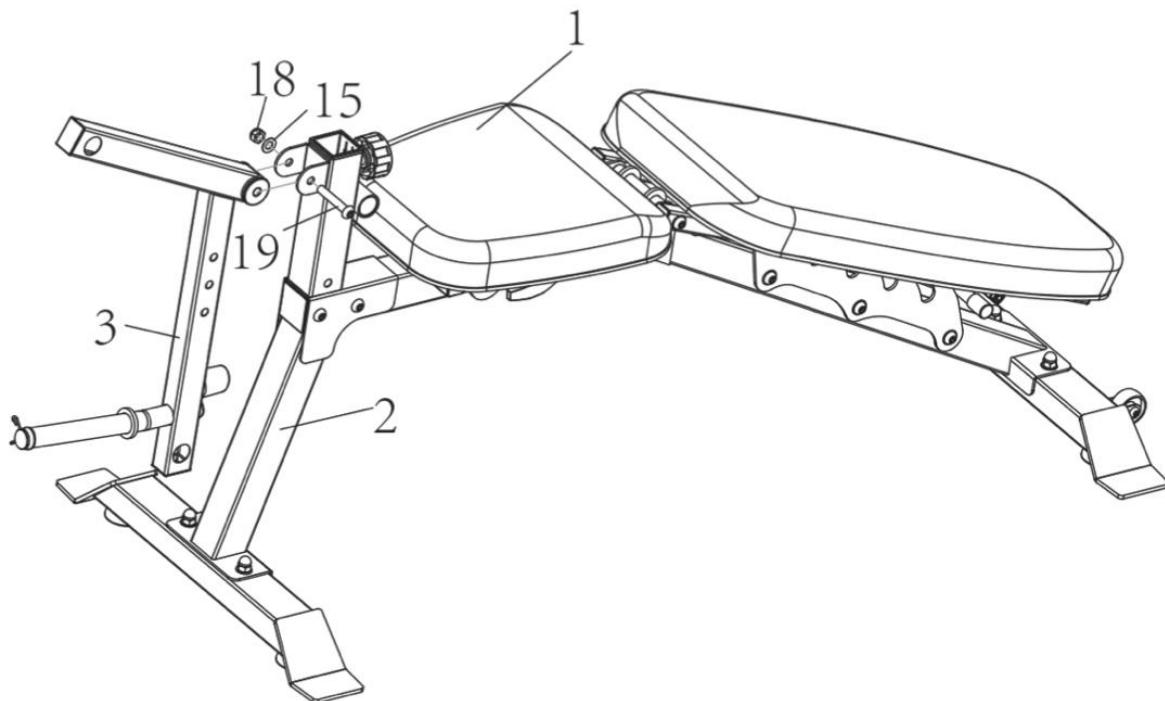
Закрепите стойку с крючком № 3 на опорной стойке № 2 с помощью шестигранного винта M10x60 № 19, одной плоской шайбы M10 № 15 и одной стопорной гайки M10 № 18. Используйте гаечный ключ с открытым концом № 12-13-17 и шестигранный ключ № 11-6, чтобы закрепить гайку по часовой стрелке.
