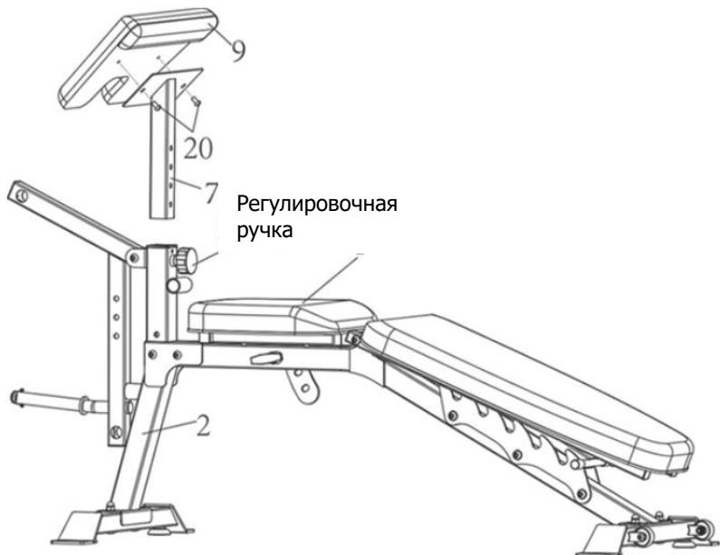
Установите кронштейн №9 на регулируемую стойку № 7 и закрепите с помощью шестигранного ключа №10-5 и двух шестигранных винтов M8\*15 №20. Ослабьте регулировочную ручку на опорной стойке № 2, затем установите регулируемую стойку № 7 на опорную стойку № 2, вставьте регулировочную ручку и затяните, чтобы зафиксировать установленные детали.
