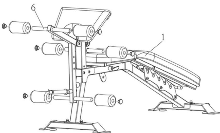
Соберите неопреновый ролик № 6, как показано на рисунке, сначала установите опорную стойку №2 и стойку с крючком №3 и затем установите неопрен и заглушку с обоих концов.
