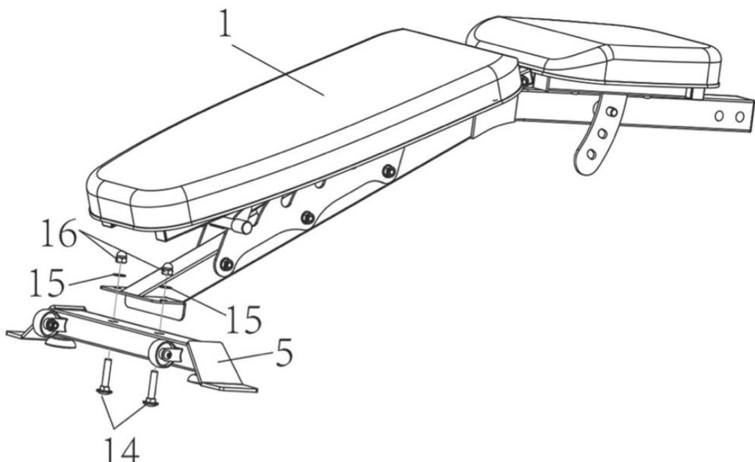
Установите задний стабилизатор № 5 на основную раму № 1 и закрепите с помощью 2 винтов M10x50 № 14, 2 плоских шайб M10 № 15 и 2 шестигранных гаек M10 № 16. Используйте гаечный ключ № 12-13-17 с открытым концом, чтобы закрутить гайку по часовой стрелке.
