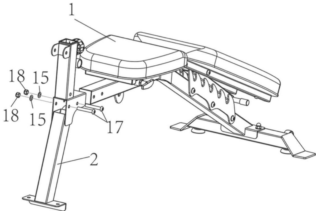
Установите опорную стойку № 2 на основную раку № 1 и закрепите с помощью 2 контргаек M10 №18, 2 плоских шайб M10 №15 и 2 шестиграных винтов № 17 M10×65. С помощью открытого ключа № 12-13-17 и шестигранного ключа № 11-6 закрепите гайку по часовой стрелке.
