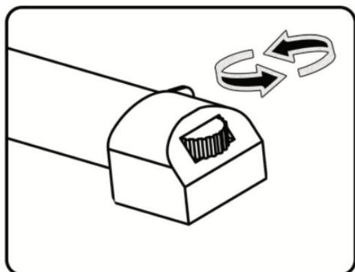
Отрегулируйте компенсаторы пола.
