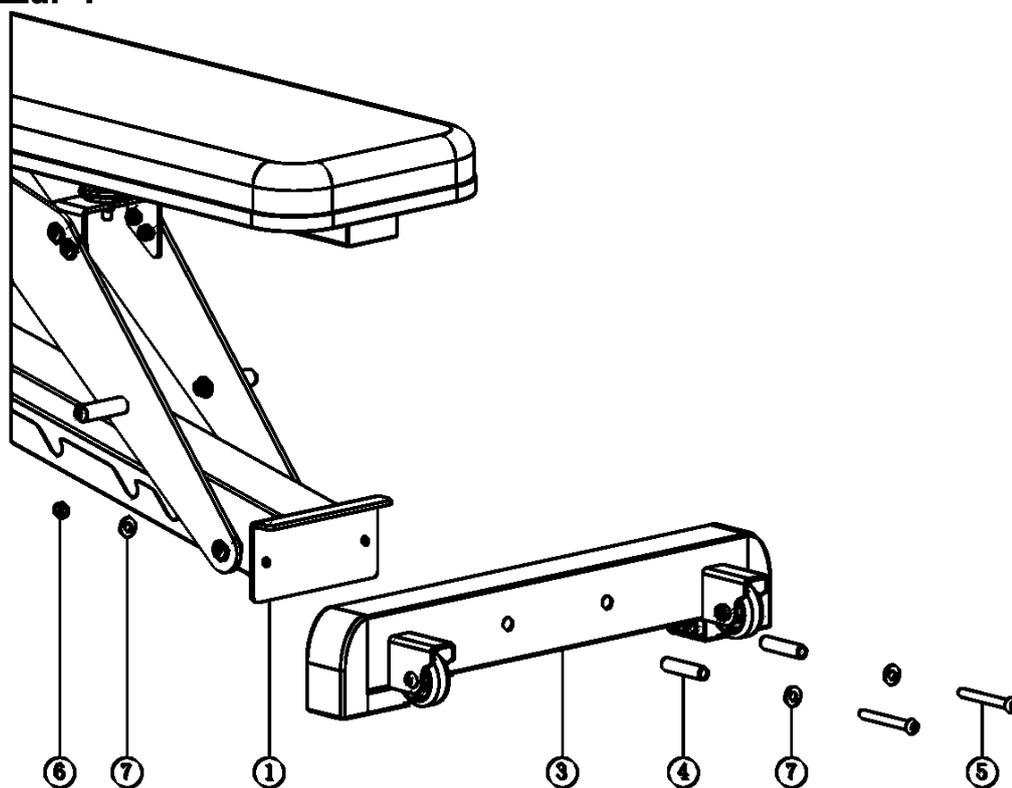
Как показано на рисунке, установите задний стабилизатор (3) на основную раму (1) и выровняйте отверстия, чтобы закрепить детали с помощью шестигранного болта М8\*65 (5), плоской шайбы d8\*D16 (7), втулки (4) по порядку, затем установите плоские шайбы d8\*D16 (7) соответственно. Крепко закрепите все детали с помощью гайки М8 (6).
