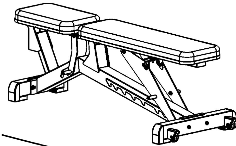
Достаньте основную раму в сборке (1), задний стабилизатор (3), 2 втулки (4), два шестигранных болта М8\*65 (5), 2 гайки М8 (6), 4 плоских шайбы d8\*D16 (7).
