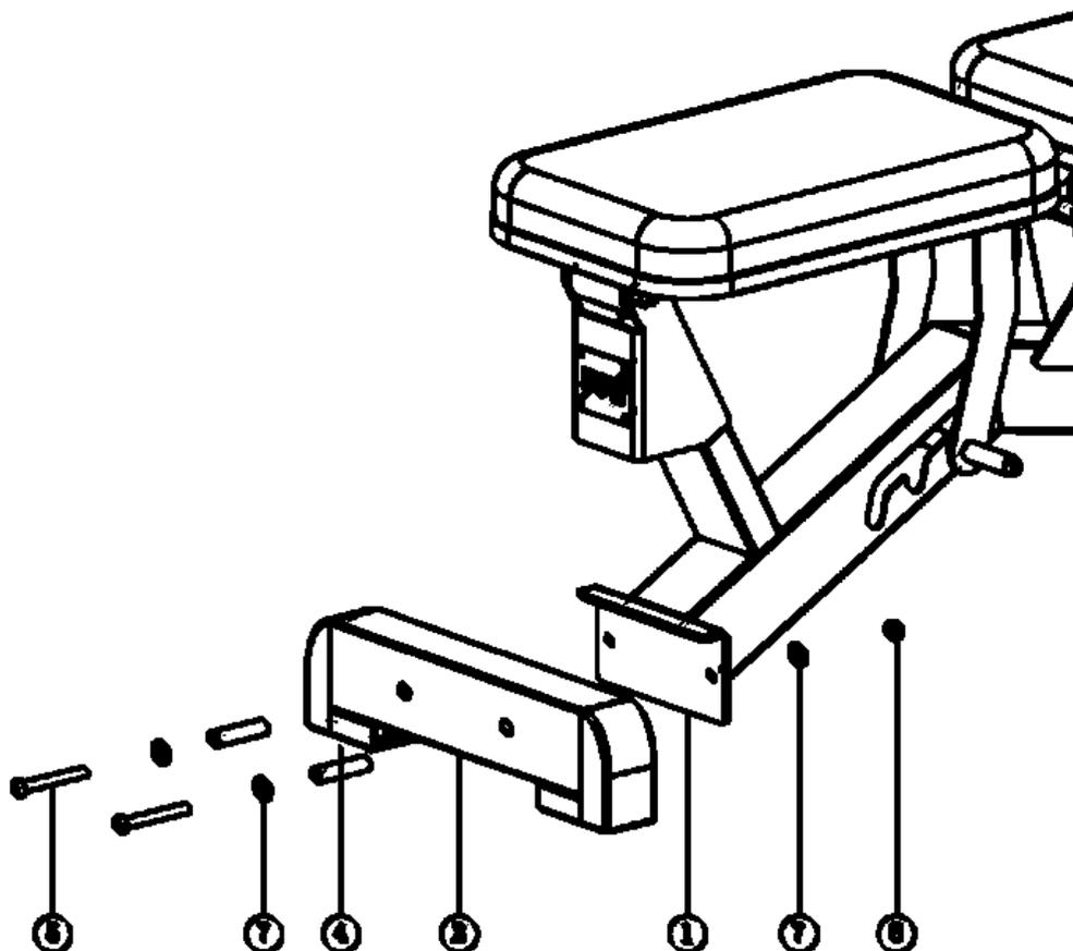
Как показано на рисунке, установите передний стабилизатор (2) на основную раму (1) и выровняйте отверстия, чтобы закрепить детали с помощью шестигранного болта M8\*65 (5), плоской шайбы d8\*D16 (7), втулки (4) по порядку, затем установите плоские шайбы d8\*D16 (7) соответственно. Крепко закрепите все детали с помощью гайки M8 (6).
