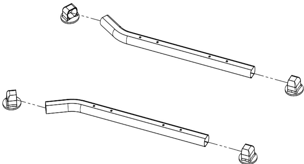
2. Установите опорную раму С × 2 на переднюю трубу В × 2 с помощью винта зажима М 8 \* 45 I × 4, как показано ниже.
