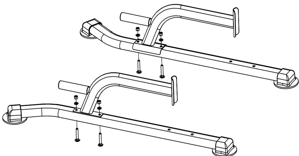
3. Установите главную раму А: используйте винт зажима М 8 \* 45 I × 4, винт с внешним шестигранником М 8 \* 75 IV \* 4, Установите 2 части главной рамы А на переднюю трубу В соотвественно следующим образом.
