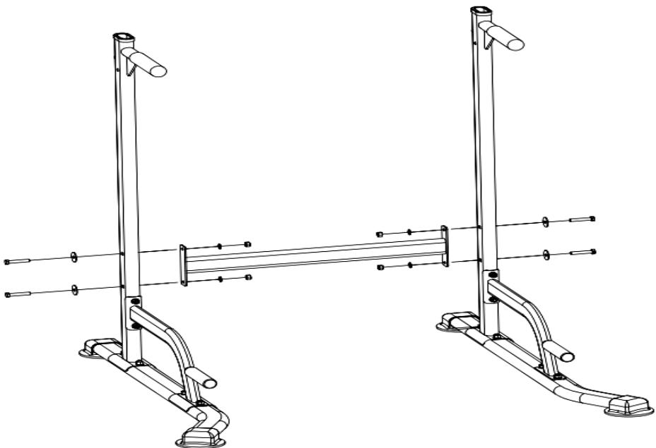
5. Установите трубу спинки F: используя винт IV × 2 с внешним шестигранником M8 \* 12, установите трубу спинки F, как показано ниже, на главную раму A.
