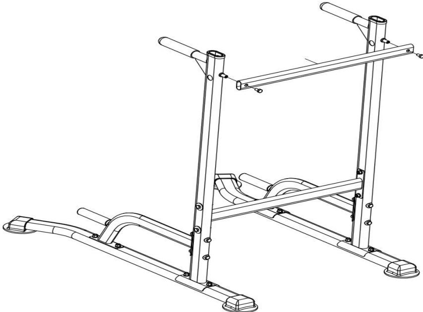
6. Установите трубку регулировки высоты D и горизонтальную перекладину G. Установите трубку регулировки высоты D, как показано на рисунке, на главную раму в нижнее положение, затем с помощью винта III\*2 с внешним шестигранником M 8\*75 установите горизонтальную перекладину.
