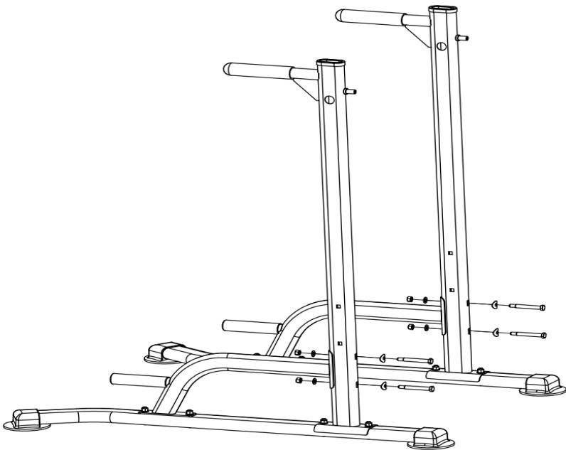
4. Установите соединение главной рамы Е: Установите соединение главной рамы Е на главную раму А с помощью винта II × 4 с внешним шестигранником М 8 \* 45 следующим образом.
