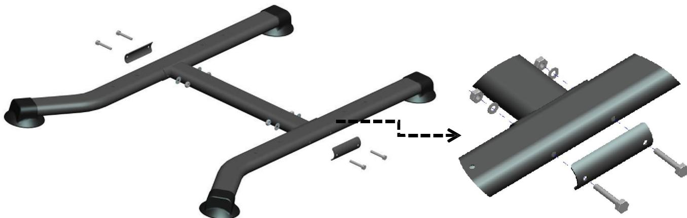
Шаг 4: Установите опорную трубку
