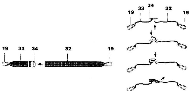
Зафиксируйте нейлоновые тросы (32) на замке петли (34), продев один конец троса в замок, сделайте петлю (33) затем другой конец троса вставьте в замок, как показано на рисунке.
