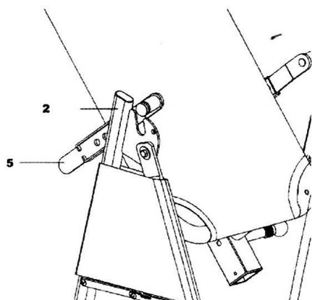
Закрепите раму ложеента (4) на задней U-образной раме(2) вставить концы регулируемой стойке ложеента (5) в отверстиях на пластинах.
