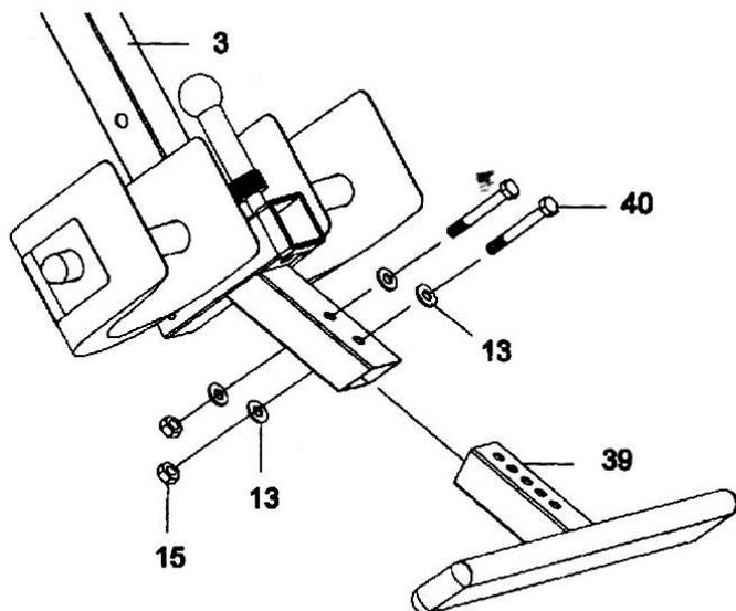
Закрепите опору для ног (39) на регулируемой стойке (3), соединив отверстия. Зафиксируйте с помощью болта(40), гайки (15) и шайбы (13).
