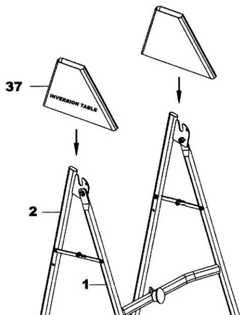
Закрепите кожура (37) на стойках, как показано на рисунке, установите их так, чтобы они закрыли стойки (8,14). На нижней части кожухов находятся липучки, застегните их. Если кожура закреплены правильно, то оси должны быть не видны.
