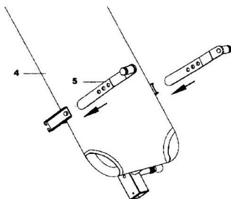
Зафиксируйте регулирующую стойку рамы (5) на кронштейнах, расположенных с каждой стороны рамы (4). Отрегулируйте на необходимом уровне с помощью защелки, вставьте втулку. Рекомендуется пользоваться защелкой до тех пор, пока вы не ознакомились с тренажером полностью.
