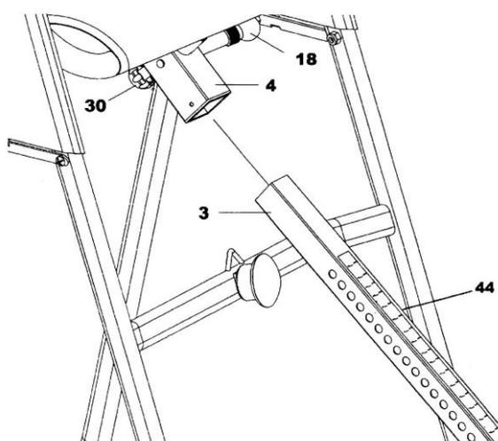
Вытяните фиксатор (18) и передвиньте регулируемую стойку (3) на раме ложемента (4), как показано на рисунке. Вставьте фиксатор обратно, выбрав интересующий вас размер на шкале (44) В целях дополнительной безопасности закрепите фиксатор (30) с обратной стороны. (См. рисунок)
