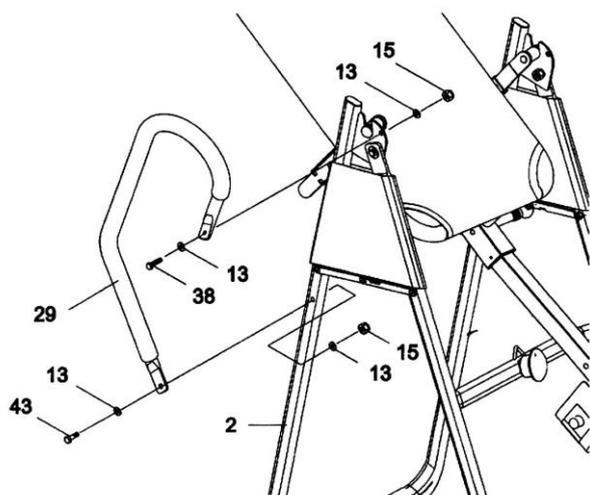
Закрепите руль (29) на задней U-образной раме (2) с помощью болтов (38,43), шайбы (13) и гайки (15), как показано на рисунке.
