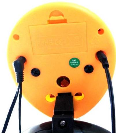
Подключите “7” glyph сзади компьютера в разъем со словом “Pulse”, “1” glyph - “Speed”.
